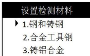
在硬度测量模式下可以测量 9 种材料：钢和铸铁、合金工具钢、铸铝合金、灰铸铁、球墨铸铁、不锈钢、铜锌合金、铜锡合金、纯铜。
